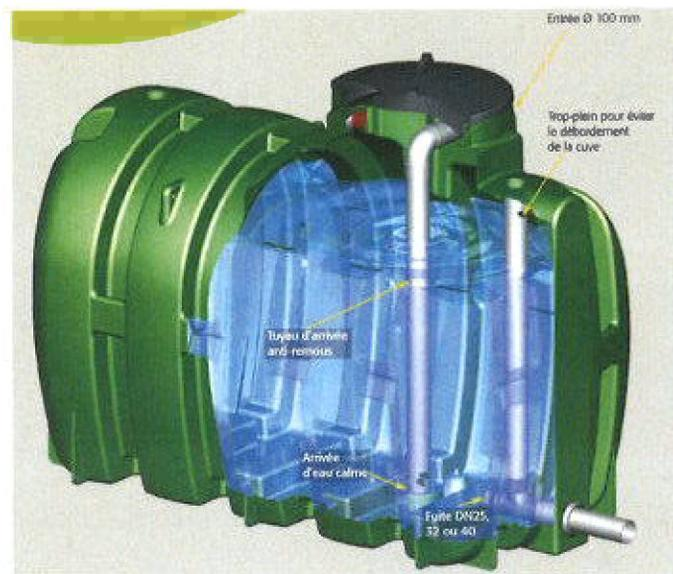
**CUVE DE RETENTION ET DE STOCKAGE DES EAUX PLUVIALES**
